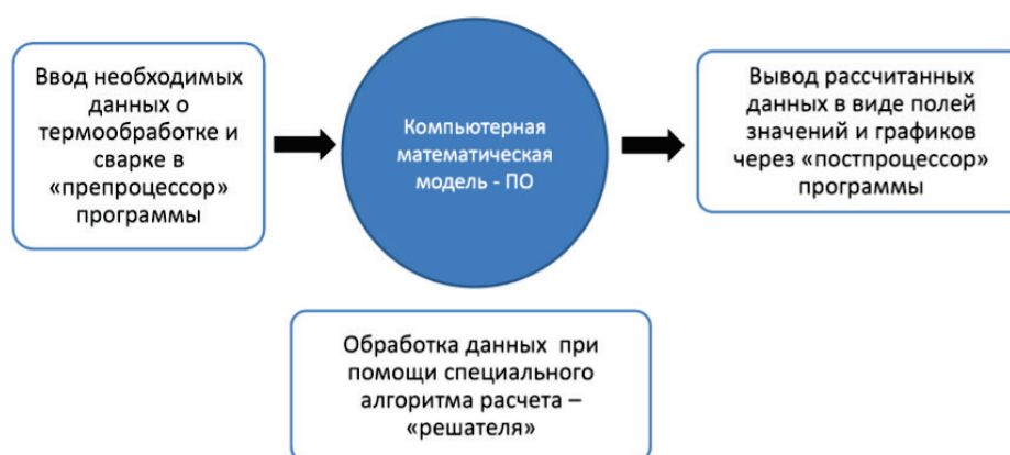
Рис. 1. Процесс компьютерного моделирования термообработки и сварки
