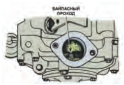
Рисунок: Внутренний байпас – проход в корпусе термостата
