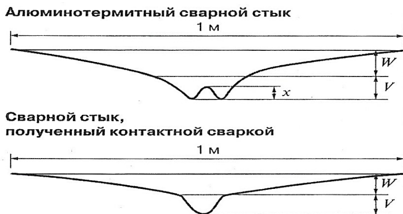
Рис. 9. Неровности сварного стыка: по СТО РЖД 1.08.002 – 2009 0,2 мм на 1 м (для скоростного движения)
