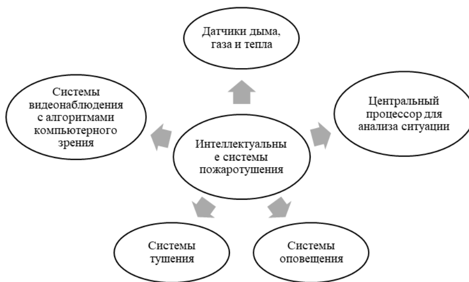
Рис. 1. Компоненты системы интеллектуального пожаротушения. Источник: составлено автором по данным [2, 4, 9].
