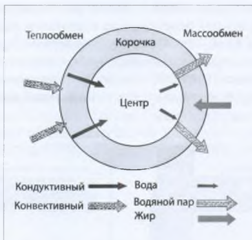
Рисунок 1 – Диаграмма тепло- и массообмена при обжаривании во фритюре [3]
