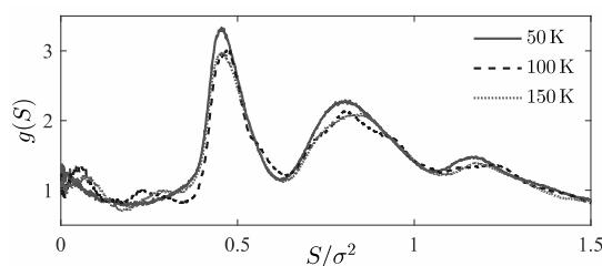
Рис. 1. Трехчастичная корреляционная функция  $g(S)$ , полученная для аморфного алюминия при температурах 50 K, 100 K и 150 K.
