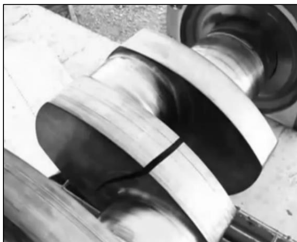
Рисунок 1 – Трещина на промежуточной щеке коленчатого вала поршневого компрессора вследствие влияния крутильных колебаний
