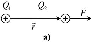
Рис.1.а)  $Q_1$  и  $Q_2$  – заряды одного знака; направления  $\vec{F}$  и  $\vec{r}$  совпадают.  $\vec{F}$  - сила отталкивания.
