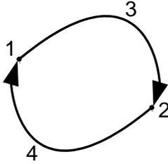
Рис.3. Работа по перемещению пробного заряда  $Q_{np}$  в электростатическом поле  $A_{132} = -A_{241}$ . Работа по замкнутому контуру:
