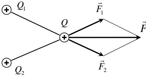
Рис.2. Суперпозиция сил, действующих со стороны поля, созданного двумя зарядами  $Q_1$  и  $Q_2$  на заряд  $Q$ .
