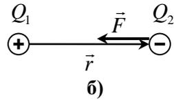
Рис.1.б)  $Q_1$  и  $Q_2$  – заряды разных знаков; направления  $\vec{F}$  и  $\vec{r}$  противоположны.
