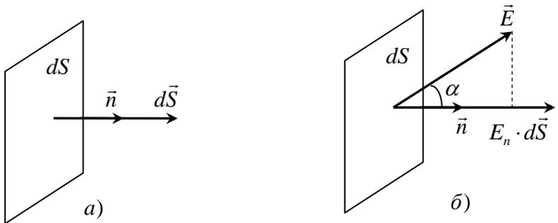
Рис.5. а) Вектор площади  $d\vec{S} = dS \cdot \vec{n}$  ; б) Поток вектора  $\vec{E}$  через  $d\vec{S}$  :
