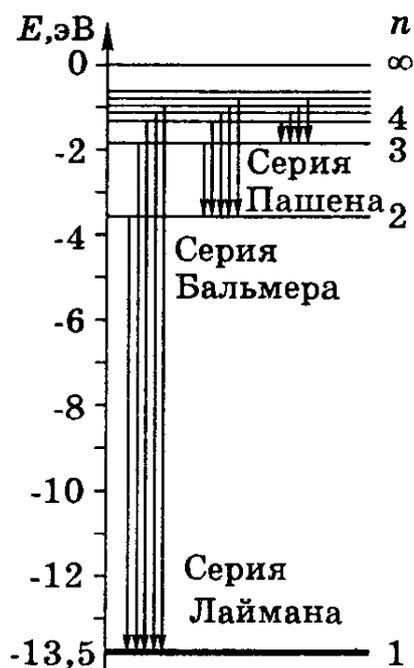
Рис. 2.2. Энергетическая структура атома водорода и спектральные серии
