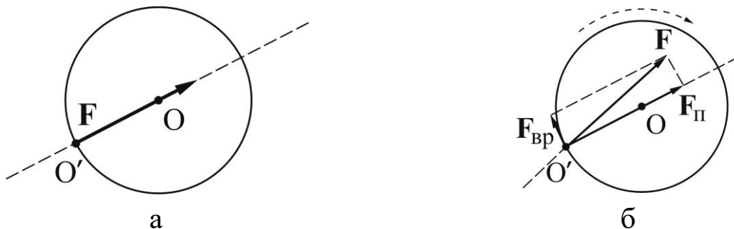
Рис. 1.41. Зависимость движения тела от направления и точки приложения силы. а) – Центральный удар – движение поступательное; б) – компонента \mathbf{F}_{\text{вр}} силы \mathbf{F} задаёт вращательное движение, а компонента \mathbf{F}_{\text{п}} – поступательное. В результате тело будет двигаться по сложной траектории
