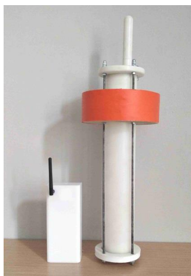
Рисунок 1 – Внешний вид системы океанографического измерительного зонда и базовой станции
