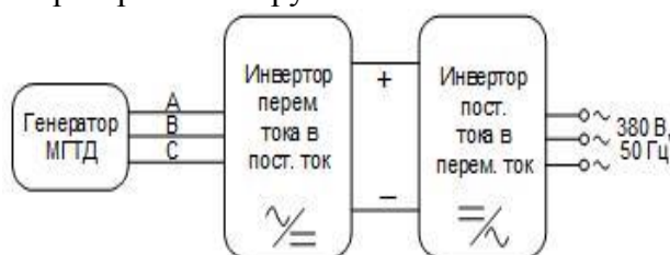
Рисунок 1 – Функциональная схема силового электронного преобразователя
