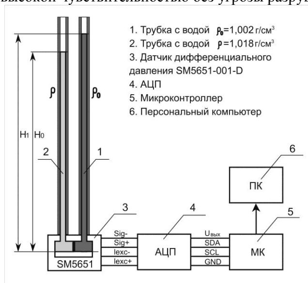
Рисунок 1 – Структурная схема макета гидростатического измерителя плотности
