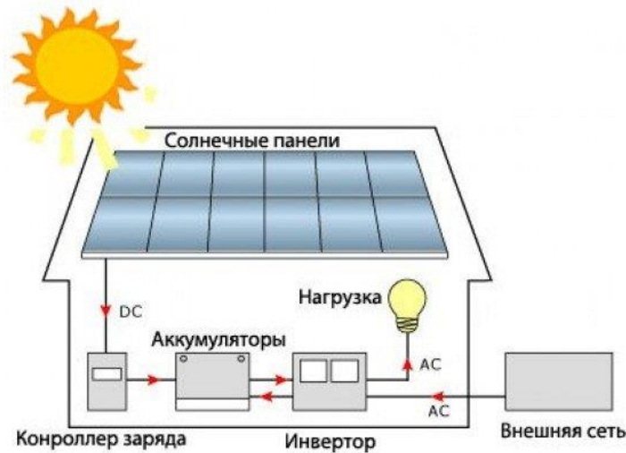
Рис. 1. Общая схема функционирования гибридной солнечной ЭС
