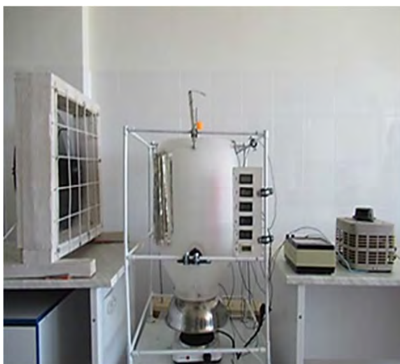
Рис. 1. Общий вид лабораторной ВВТЭУ с ротором Н-Дарье и плоским теплоэлектронагревателем
