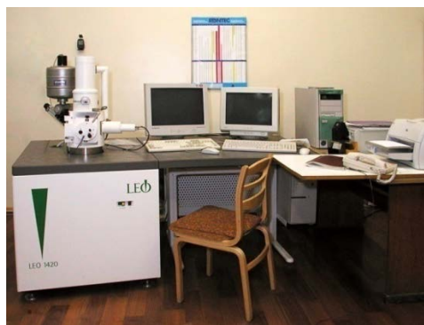
Рисунок 1. – Сканирующий электронный микроскоп LEO 1420 (Германия)
