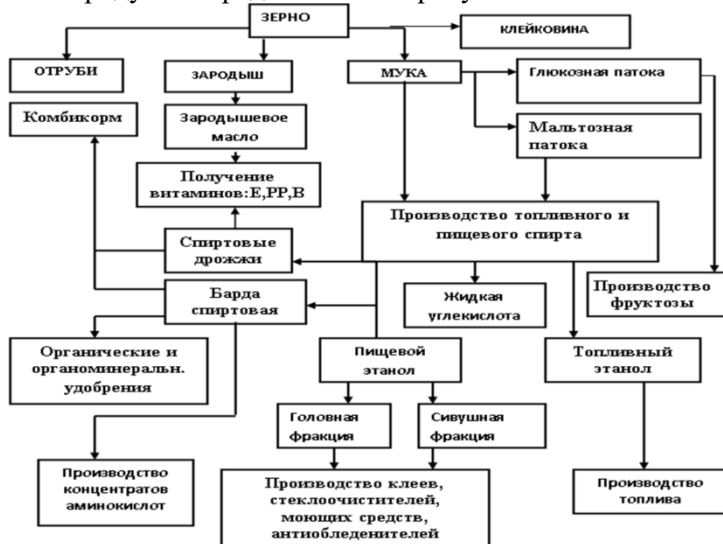
Рисунок 2 - Блок схема переработки зернового сырья с получением пищевых, кормовых и технических продуктов
