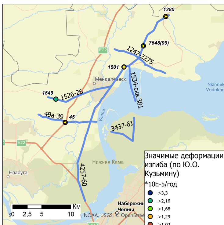
Рис. 7. Распределения мест систематических посадок, для которых уровень относительного деформирования геологической среды является опасным или условно допустимым: а) зона Ромашкинского полигона; б) Прикамская зона.
