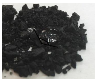
Рис. 2. Определение угла смачивания сорбента
