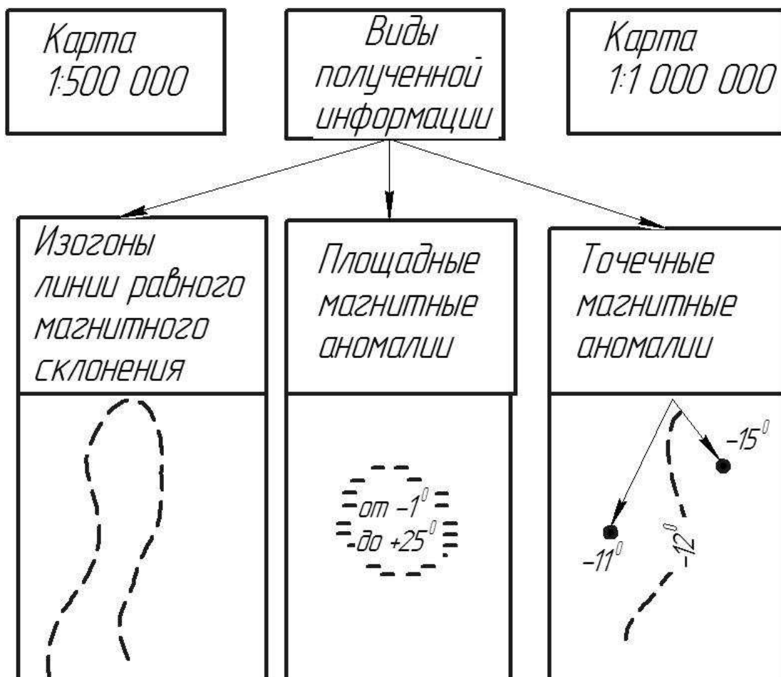
Рисунок 39 – Ориентирование линий по магнитному меридиану
