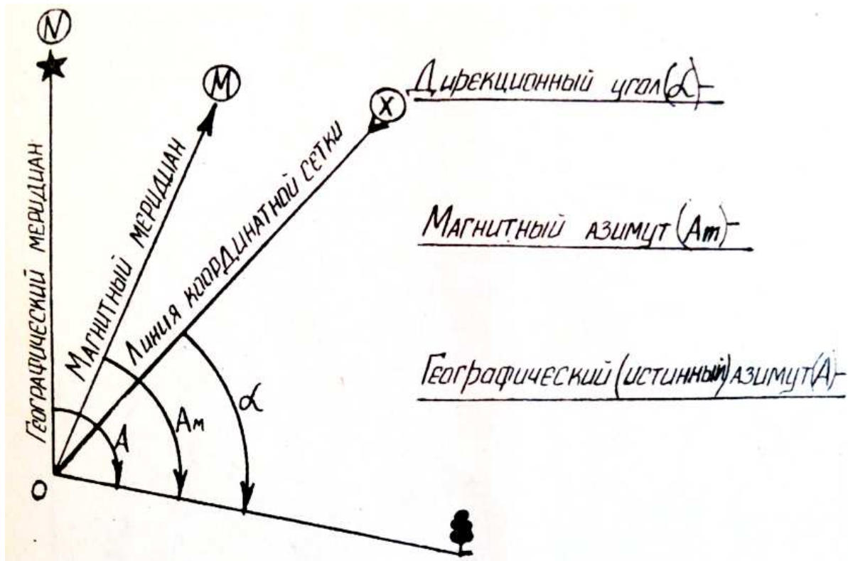
Рисунок 38 – Определение азимута и дирекционных углов
