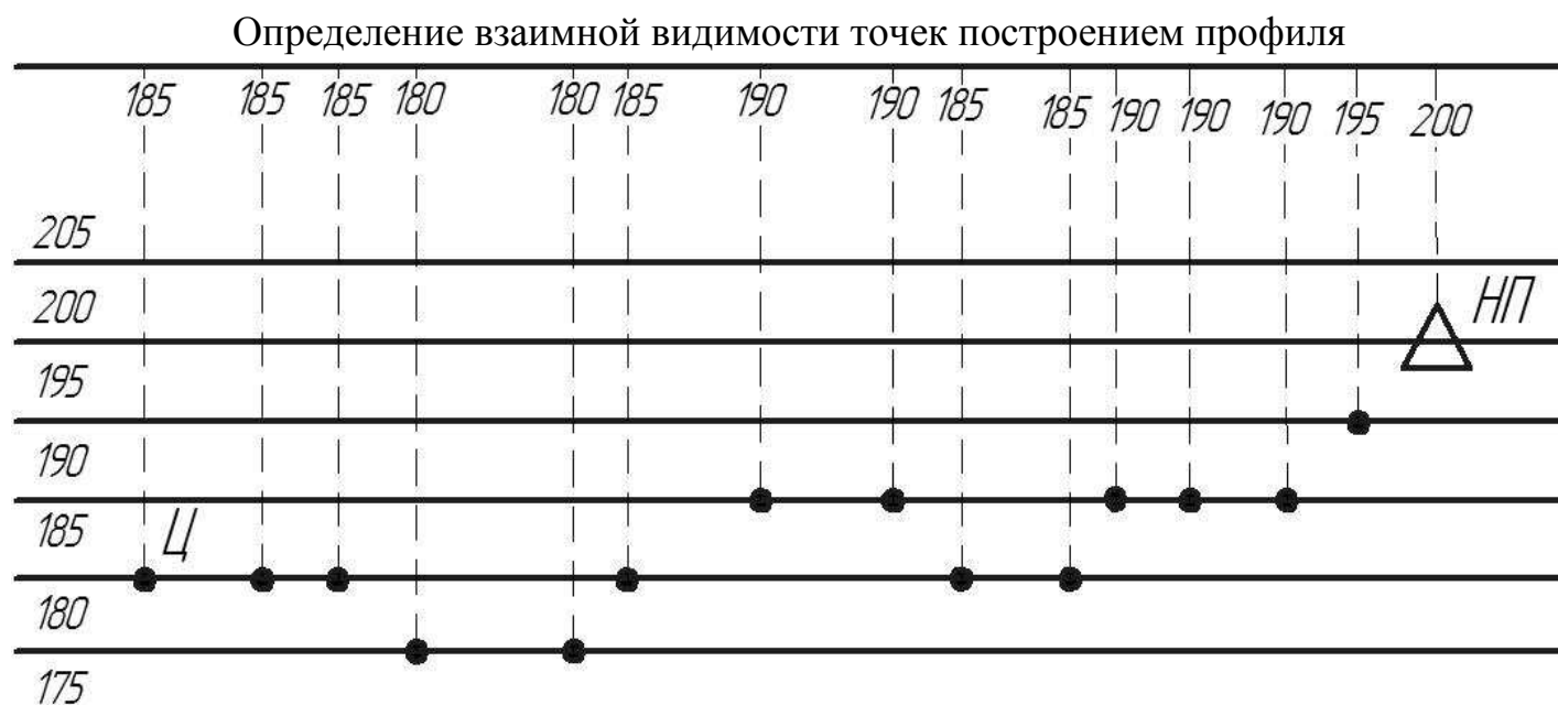
Рисунок 20 – Определение взаимной видимости точек построением профиля
