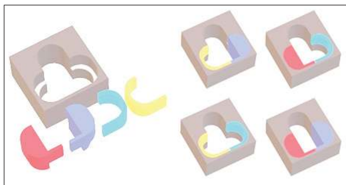
Рис. 1. Объемные цифровые модели коллиматора и вставок (слева) и варианты их размещения (справа)
