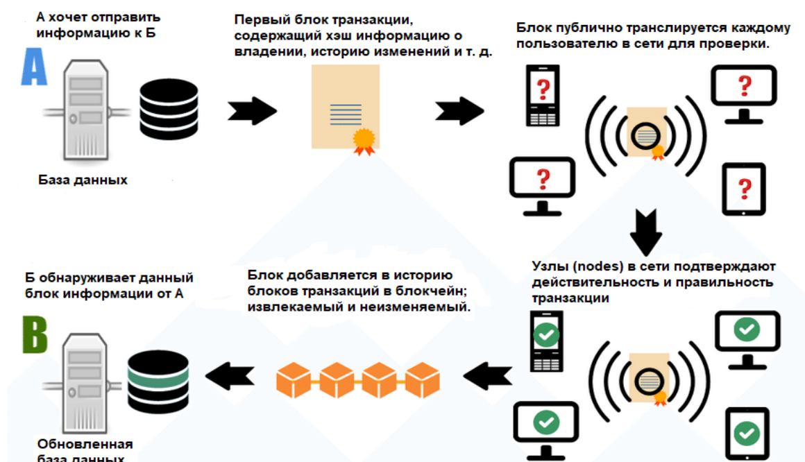
Рис. 1. Обзор принципа работы блокчейна [3].
