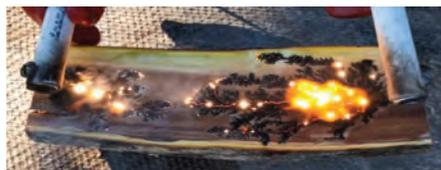
Рис. 3. Процесс выжигания электрохимическим способом.
