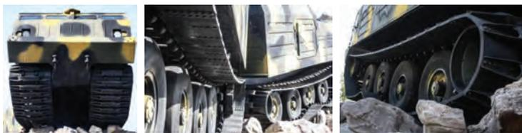
Рис.4. Резинометаллические гусеницы движителя
