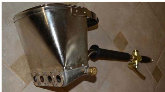
**Рис. 1. Пневмолопата - хопер**
