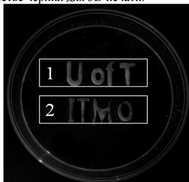
Рис. 1. Напечатанная 3D модель с использованием гелей на основе углеродных квантовых точек и модифицированной нанокристаллической целлюлозы с использованием растворителей разной полярности под УФ возбуждением с наблюдаемой эмиссией в разных областях спектра.
