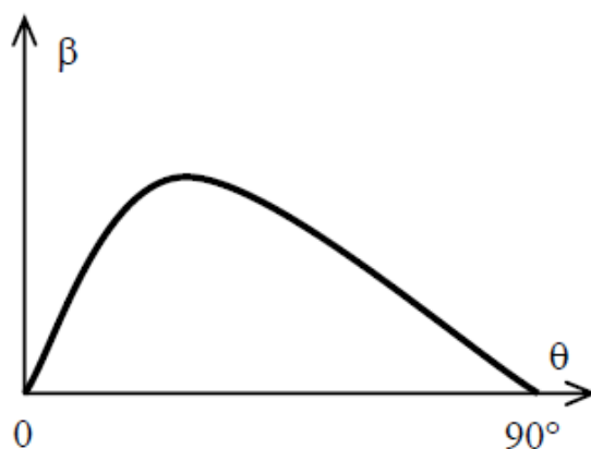
Рис. 6.19. Зависимость угла поворота потока от угла наклона пламени к набегающему потоку
