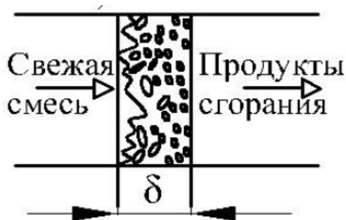
Рис. 3.14. Схема пламени при крупномасштабной турбулентности [1]
