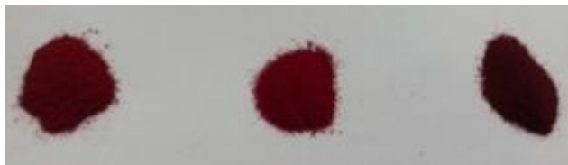
Рис.2. Образцы с содержанием 5% (по массе) антоцианов при инкапсулировании в: а – мальтодекстрине, б – карбоксиметилцеллюлозе, в – пектине
