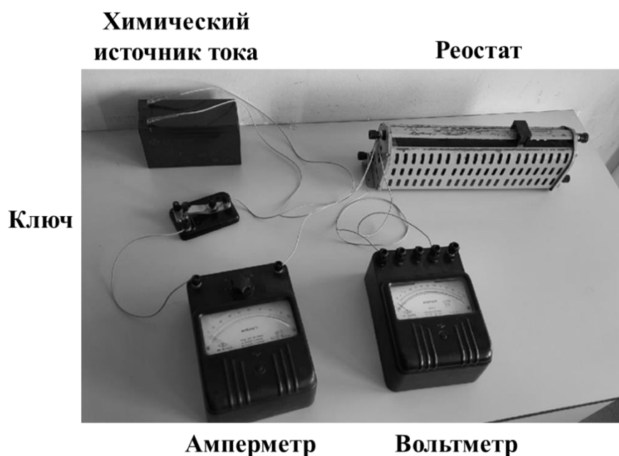
Рис. П.7. Фотография экспериментальной установки для определения внутреннего сопротивления и ЭДС источника тока
