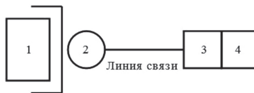
Рис. 1. Обобщенная структурная схема САОУН: 1 – объект контроля; 2 – первичный датчик контроля; 3 – устройство обработки информации; 4 – устройство индикации
