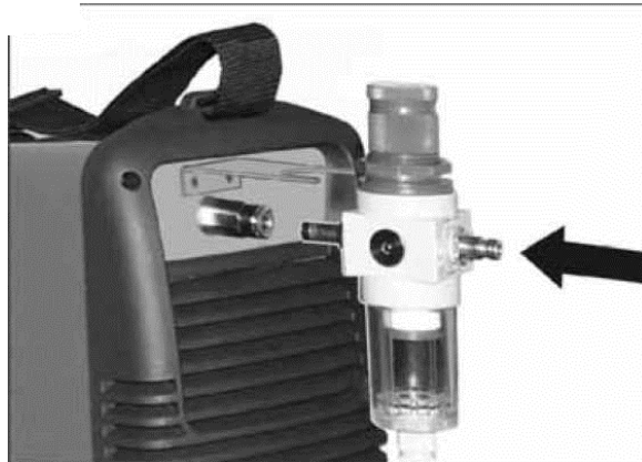
Рис. 3. Подключение сжатого воздуха к плазматрону
