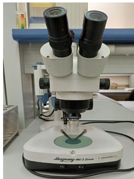
Рисунок 14. Оборудование и расходные материалы, необходимые для проведения биотестирования с инфузориями (а - планшета с лунками, б – бинокуляр)
