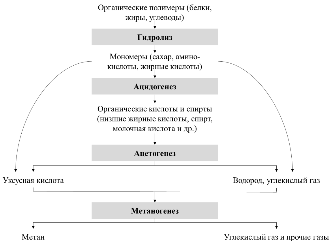
Рисунок 3. Этапы разложения органического вещества в процессе анаэробного сбраживания
