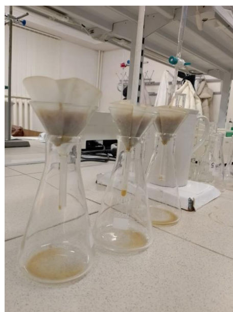
Рисунок 9. Приготовление водных вытяжек.
