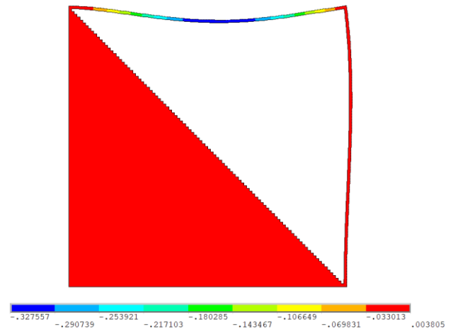
Рис. 6. Поле узловых перемещений вдоль вертикальной оси (10 000 КЭ, ANSYS)
