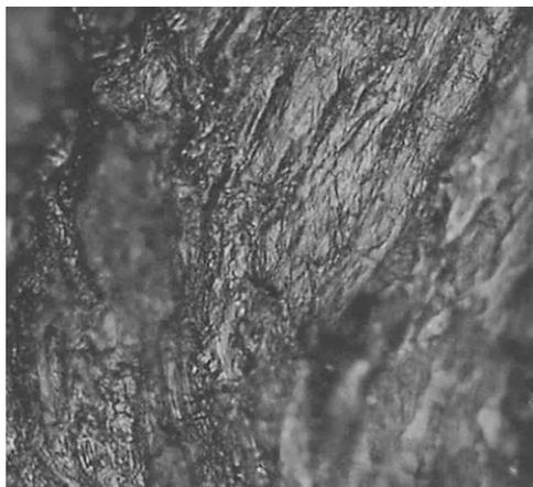
**Рисунок 3.** Изображение поверхности топливной гранулы после обработки плазмой ВЧИ разряда.
