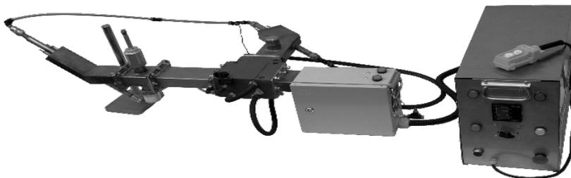
**Рисунок 1.** Общий вид источника нетермальной аргоновой плазмы атмосферного давления
