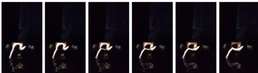
**Рисунок 3.** Пробои между отдельными частями изогнутого канала разряда с жидким анодом (интервал между изображениями 1 мс)
