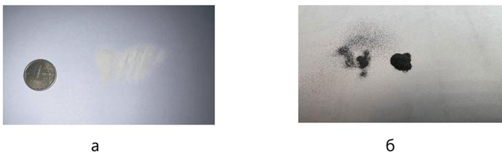
**Рисунок 5.** Внешний вид порошка Al<sub>2</sub>O<sub>3</sub> дисперсностью 50 мкм: а – исходный, б – с титановым PVD-покрытием
