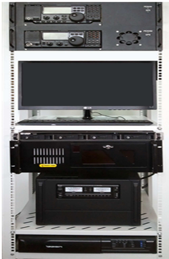
Рис. 2. Однопозиционный вариант автоматизированного двухканального АЗИ
