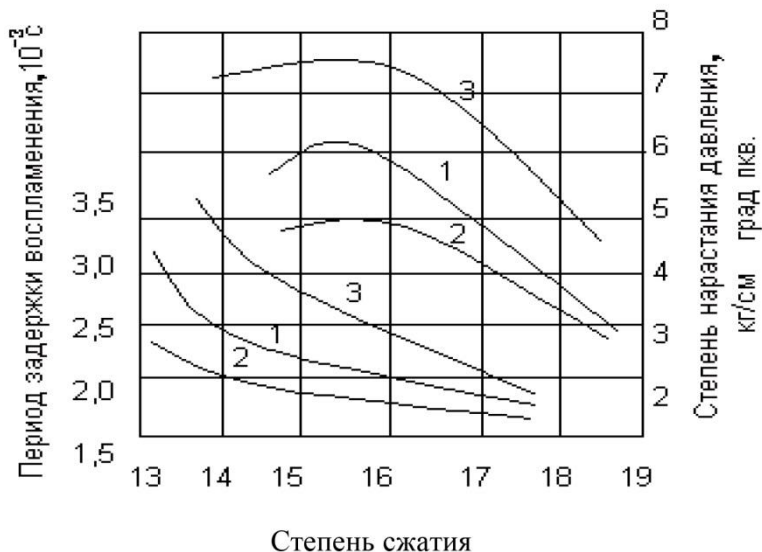
Рис.2.3. Влияние степени сжатия на ПЗВ и скорость нарастания давления в дизеле: 1 – дизельное топливо; 2 – алканоцикловая фракция дизельного топлива; 3 – ароматическая фракция дизельного топлива
