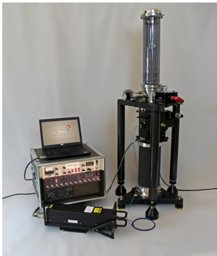
Рисунок 15. Баллистический гравиметр MicroG-LaCoste FG5-X
