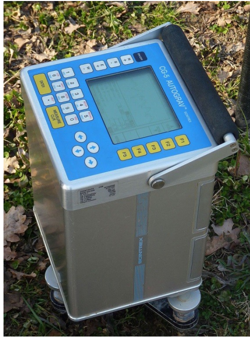
Рисунок 18. Гравиметр Scintrex CG-5 Autograv.
