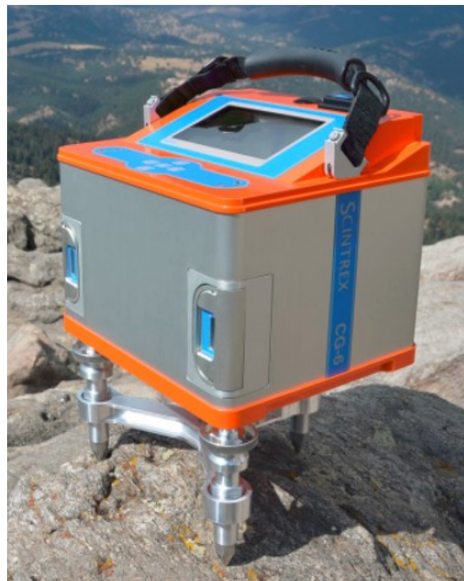
Рисунок 19. Гравиметр Scintrex CG-6 Autograv
