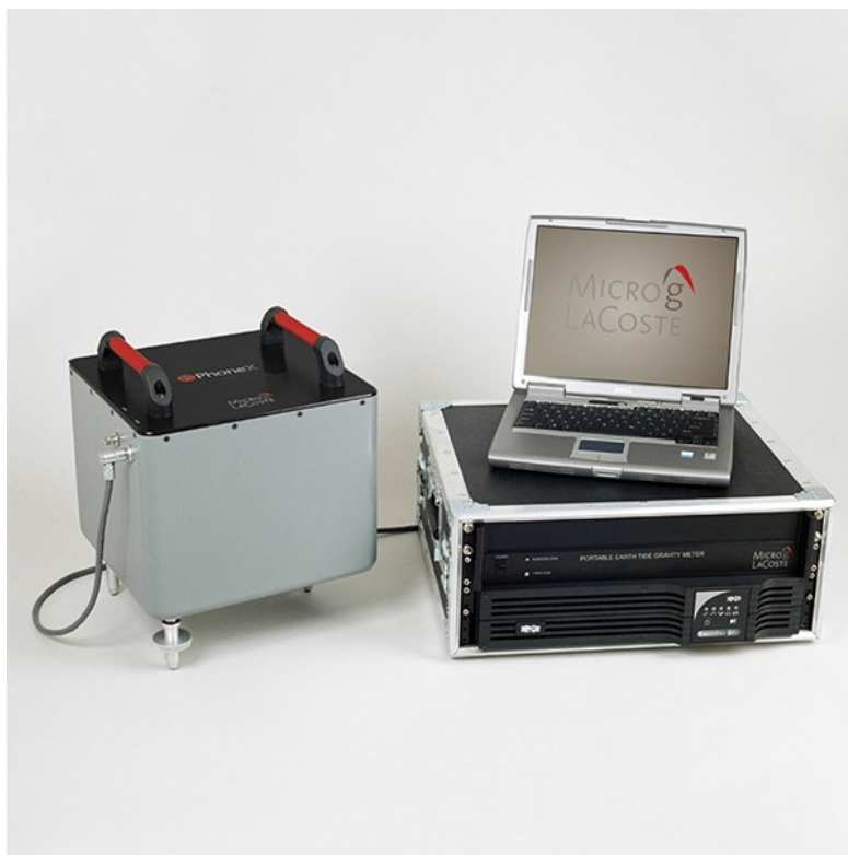
Рисунок 20. Гравиметр Micro-g LaCoste gPhoneX
