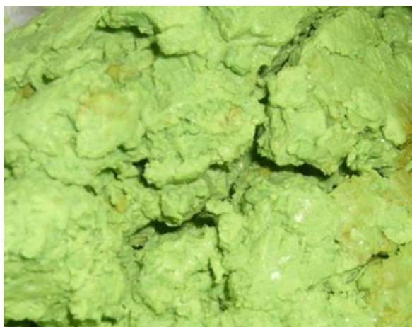
Рис. 1. Гальваношлам предприятия ОАО «Роберт-БОШ-Саратов» после ванн никелирования
