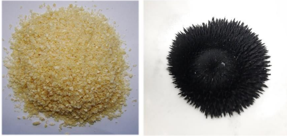
Рис. 3. Исходный хитозан (слева), магнитные частицы хитозана (справа)
