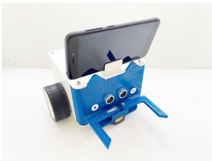
Рисунок 2. Мобильный робот на базе платформы Arduino Uno с закрепленным на нем смартфоном
