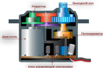
Рис. 1. Сервопривод в разрезе
