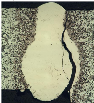
Рис.1. - Общий вид сварного шва пластин ЧВГ 30 (слева) и ЧВГ 35, увеличение \times 50 , (шлиф травлен).
