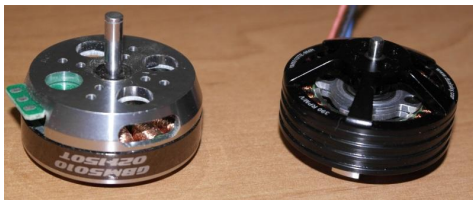
Рис. 4. Слева мотор для привода оси гиropлатформы, справа для привода воздушного винта.
