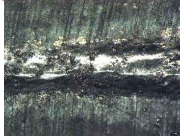
Рис.3. – Внешний вид поверхности сварного шва пластин ЧВГ 35 и ЧВГ 30, при повышенном расходе аргона, увеличение \times 75
