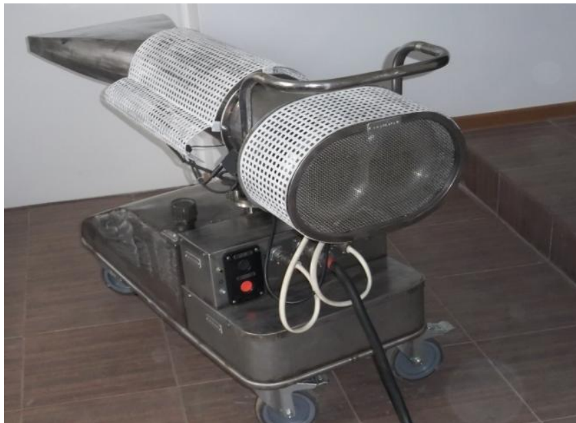
Рисунок 2 – Теплогенератор без разделения потоков воздуха и продуктов горения
