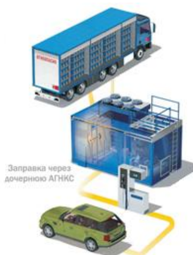
Рисунок 4 – Схема доставки КППГ через дочернюю АГНКС
