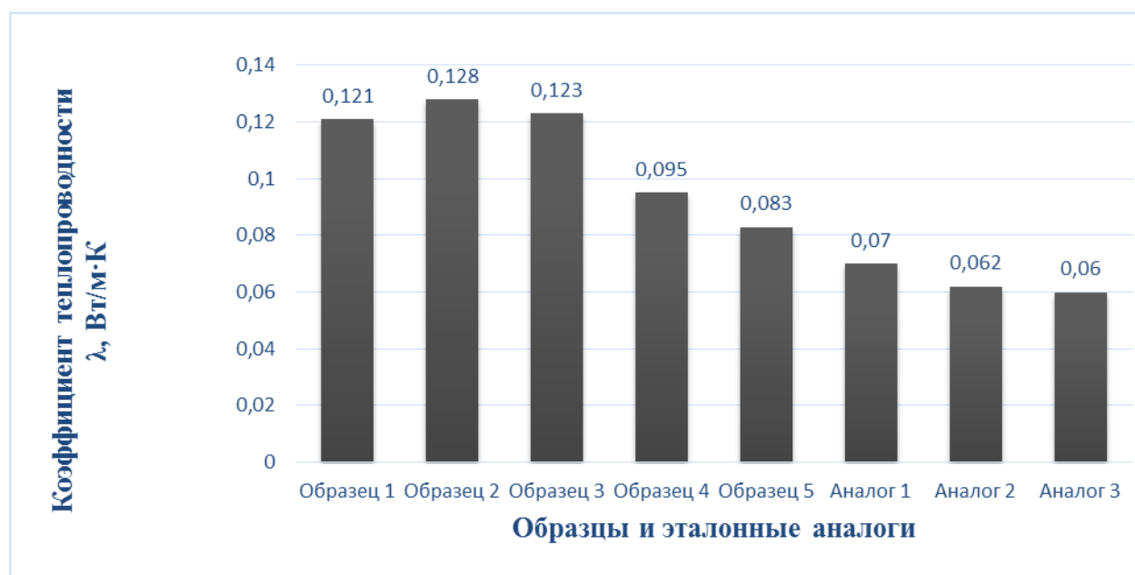
Рисунок 1. –Диаграмма сравнительного анализа коэффициента теплопроводности матричных полиуретановых материалов эталонных аналогов.
