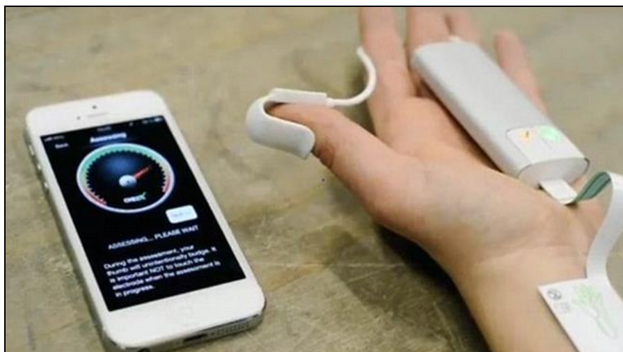
Рисунок 3 – Прибор Check для стимуляции специфической нервно-мышечной реакции мозга
