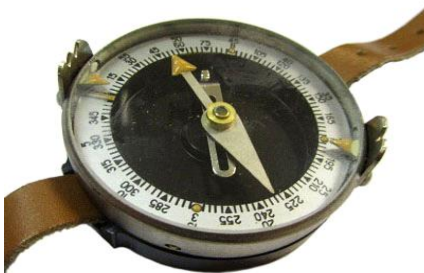
Рис.12. Компас Адрианова (магнитный компас)
