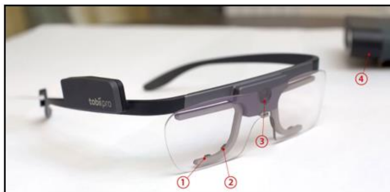
Рис. 2. Мобильная система регистрации окуломоторной активности, где: 1 – инфракрасная подсветка; 2 – камера регистрации движения глаз; 3 – камера записи изображения окружающей среды; 4 – записывающее устройство [6]
