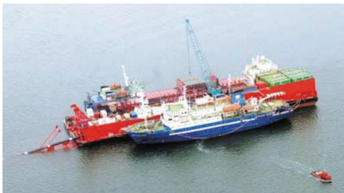
Рисунок 2 - Трубоукладочное судно MRTS Defender
