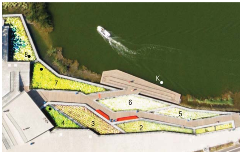
Рис. 2. Схема расположения прудов фито-очистной системы. Точками указаны места отбора проб в озере Нижний Кабан (К) и в прудах (4, 7, 8)
