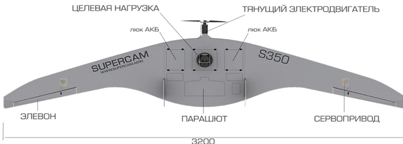
Рис. 1. БПЛА Supercam S350
