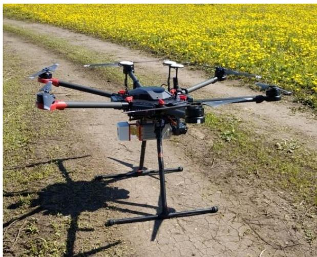
Рис.1. RIEGLminiVUX-2UAV на базе БПЛА Matrice 600
