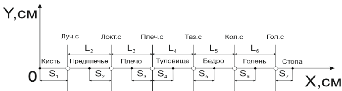
Рис. 11. Индексное обозначение расстояния от антропометрической точки сегмента до его центра масс ( S_i )
