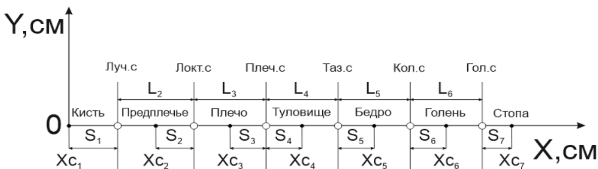
Рис. 12. Индексное обозначение координат центра масс сегментов ( X_{c_i} , Y_{c_i} ). Обозначения координат центра масс сегмента: X_{c_1} , Y_{c_1} – координата центра масс кисти по осям Ox , Oy . X_{c_2} , Y_{c_2} – координата центра масс предплечья по осям Ox , Oy . X_{c_3} , Y_{c_3} – координата центра масс
