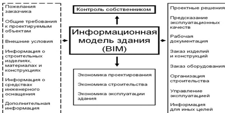
Рис. 1. Схема функционирования BIM-технологии
