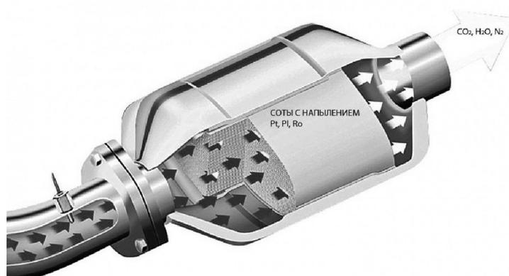
Рис. Каталитический нейтрализатор
