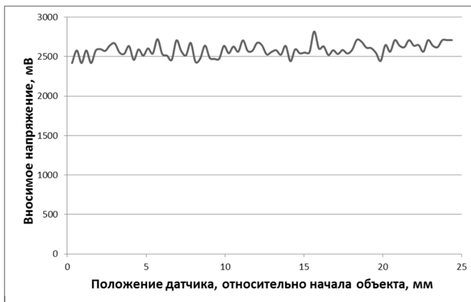
б – Величина отклика при сканировании сварного шва образца №2
