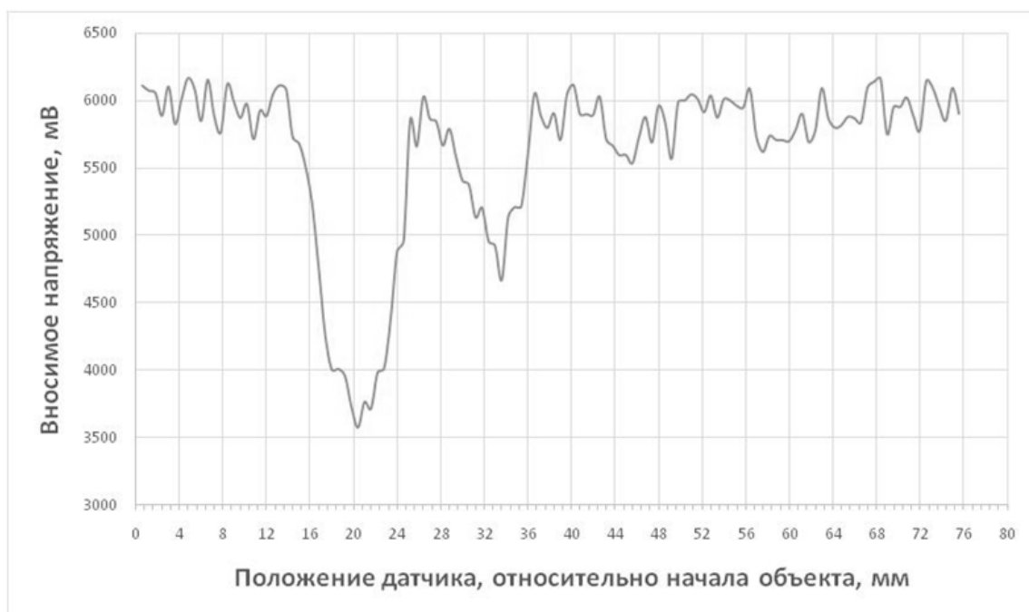
б – Результаты сканирования пластины №2 без системы фильтрации и селективного усиления
