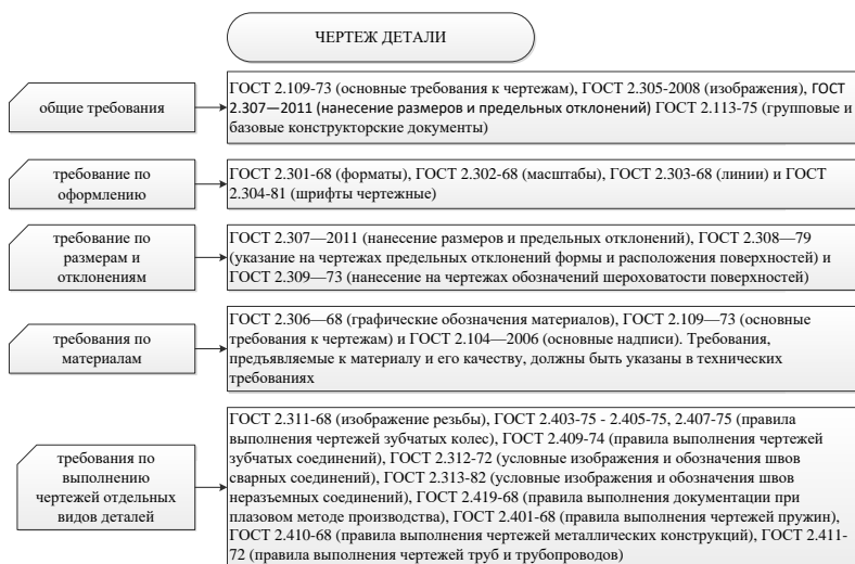
Рисунок 2.3.2. Требования ГОСТ к чертежу детали
