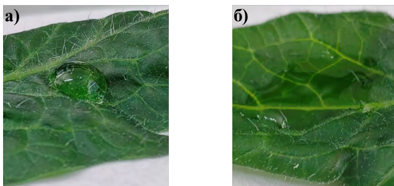
Капля раствора имидаклоприда (0.1 мл) на листе томата; а – водный раствор, б – раствор, содержащий 0.1% вес. ПАВ.
