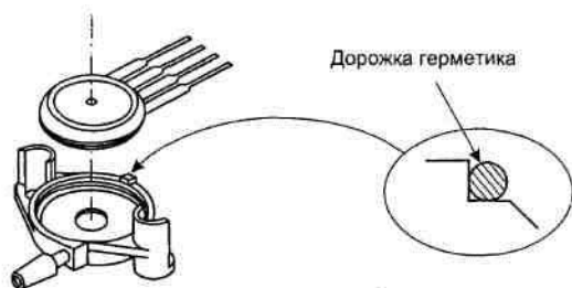
Рис. 18.7. Современный интегральный датчик давления в защитном корпусе
