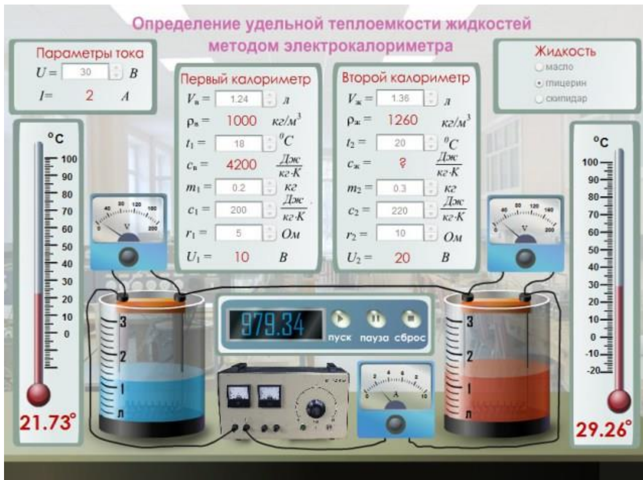
Рис. 1. Электронная интерактивная установка для определения удельной теплоемкости жидкостей методом электрокалориметра
